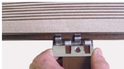
Placez le bord de la fixation sur le côté de la lambourde, pour que la vis soit centrée par rapport à celle-ci.
